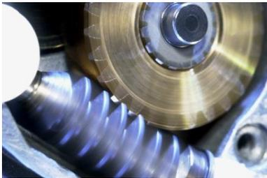
Die exakte Kenntnis der Werkzeug- und Zahnradflanken ist unabdingbar für die Entwicklung und Optimierung von Getrieben. Die räumlichen Geometrien von Zahnrädern sind sehr komplex und erfordern erheblichen Programmieraufwand.
